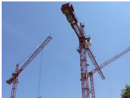
Mit Traglasten von jeweils max. 8 Tonnen sind die WÖLFFE optimal für das Heben schwerer Fertigbauteile geeignet.
